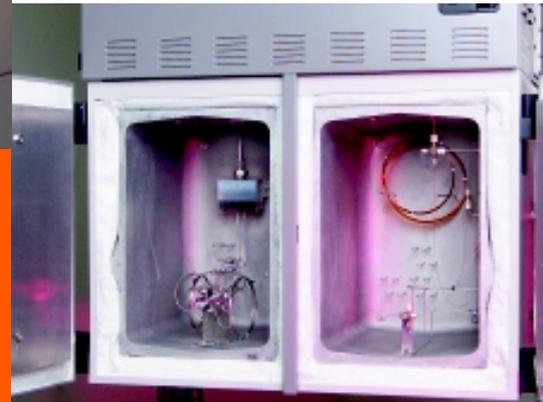
在每个 8 池热敏电阻检测器模块内都有 6 个独立并带参比的检测通道。这样，在一台 Maxum II 型工业色谱中就有多达 18 个独立的检测通道供用户使用。
