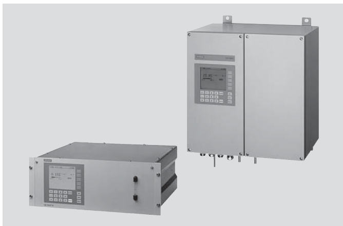
OXYMAT 6, 19" 机架式和现场式 OXYMAT 6 型氧分析仪基于磁压原理来测量气体中的氧浓度。
